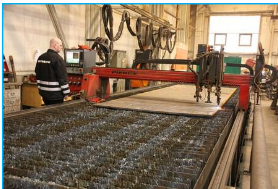
55) Řezání železné desky – Cutting of an iron plate (Foto: J. Kukla)
