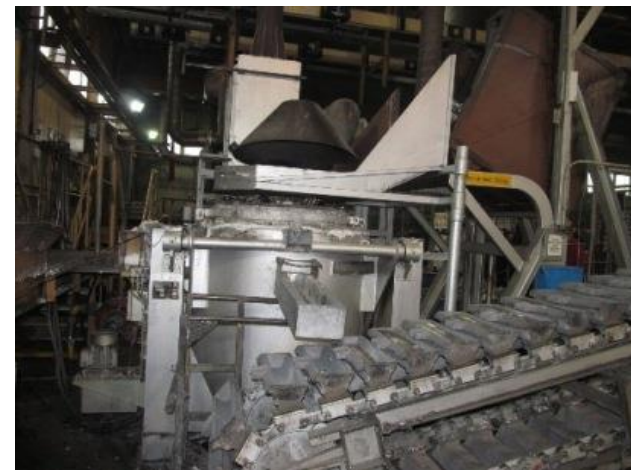
dopravník pro odlévání ingotů
