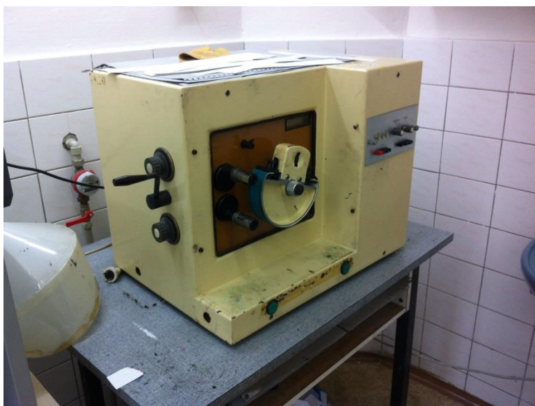
Obrázek 8 Cílem praktického vyučování pro střední management firem je rozpoznat podstatu technických problémů ve výrobě. K tomu dopomáhá například přístrojové vybavení pro měření nánosu barvy na papíře. Autor: Vladimír Lukeš.
