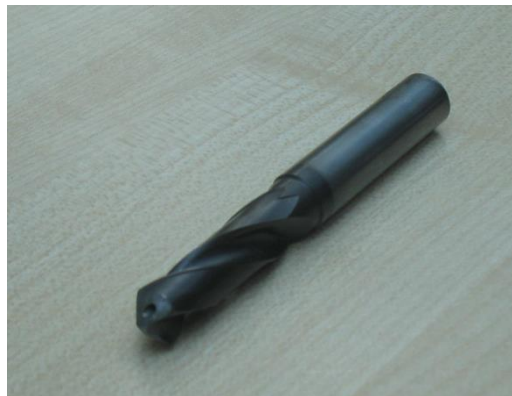
Obr. 13: Monolitní vrták
