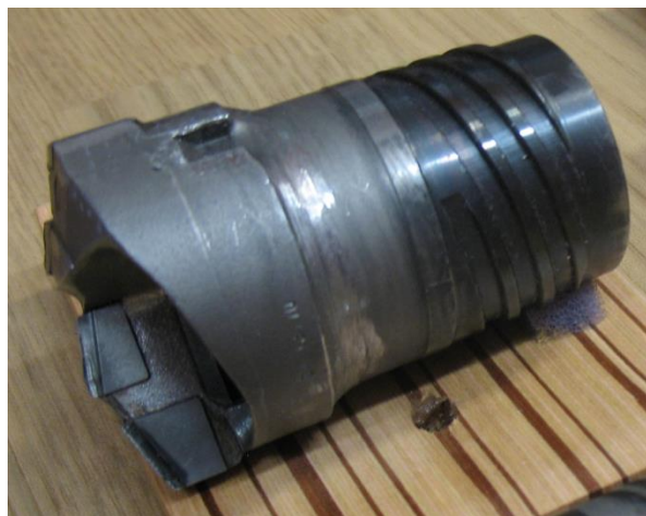
Obr. 21: Ejektorová vrtací hlavice
