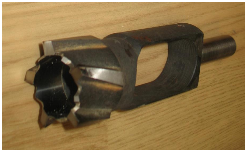
Obr. 17: Jádrový vrták vhodný na dřevo, umělé hmoty
