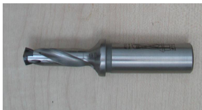
Obr. 14: Připájený monolitní vrták
