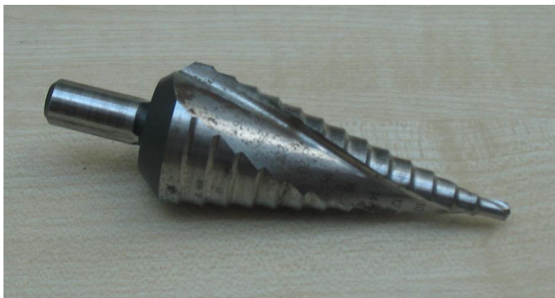
Obr. 19: Stupňovitý vrták
