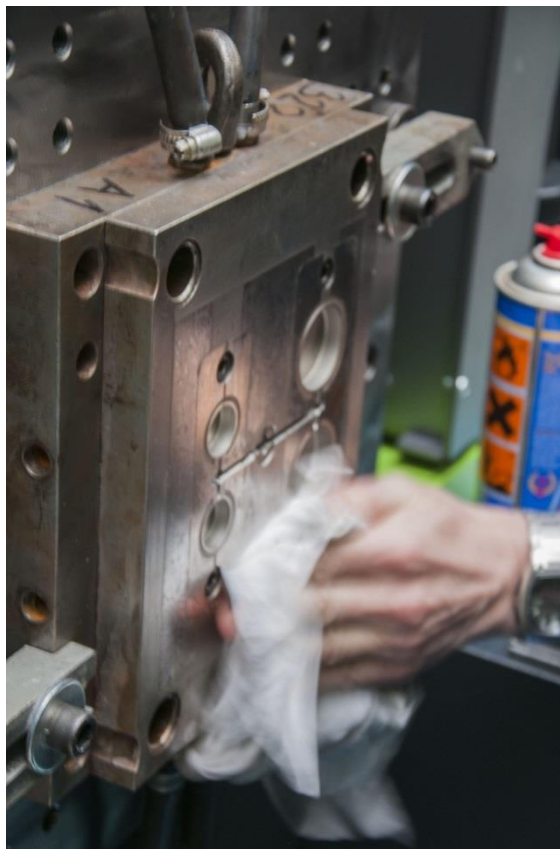
Reálný příklad odstranění nečistot z formy
