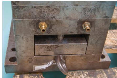
Vstup a výstup temperačního systému formy
