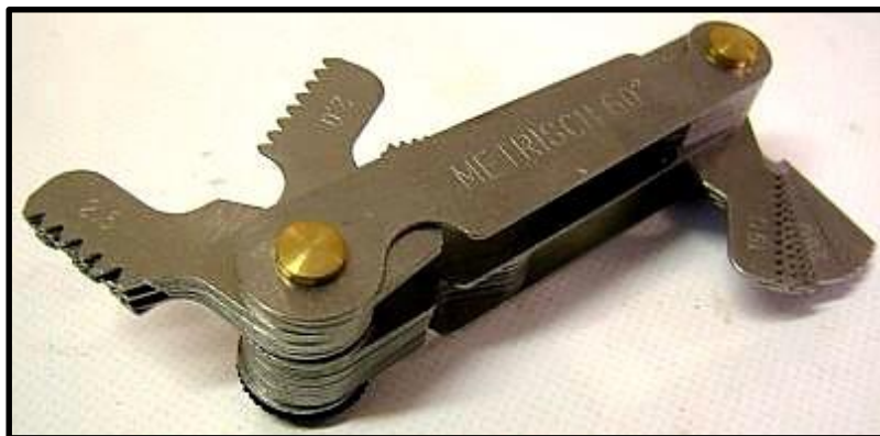
měrka na kontrolu stoupání závitů
